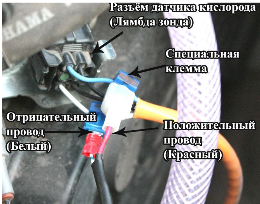
Рисунок 3.2. Методика подключения проводов при помощи специальных клемм «крокодилов»
