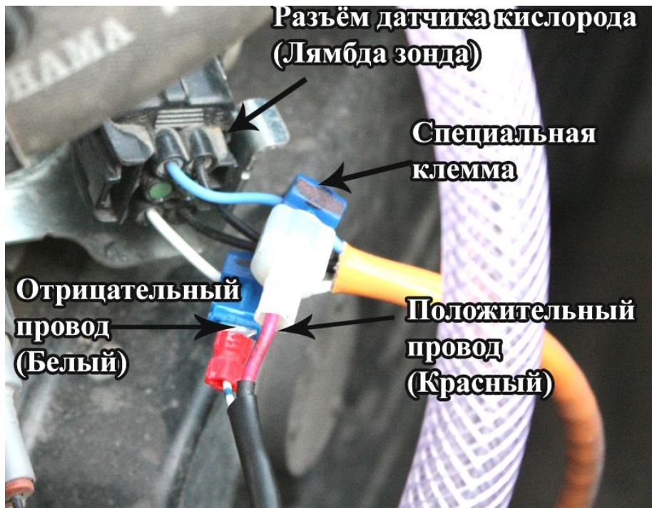
Рисунок 3.2. Методика подключения проводов при помощи быстрых соединителей.
